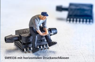
keine Angriffsfläche, da nur das Kunststoffgehäuse, ein Keramikträger mit einer dünnen Schicht Silikonklebstoff und die Siliziummesszelle selbst in Kontakt mit dem Medium stehen. Daher sind die SOIC-Sensoren SM9336 einseitig wasserresistent.
